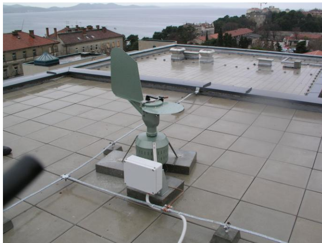
Slika 1. Automatski uzorkivač tipa Hirst na mjernoj postaji Zadar
